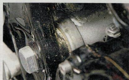
Und diese Sauerei sieht zum Beispiel so aus: massive, irreparable Säureschäden auf dem Schwingenlager
